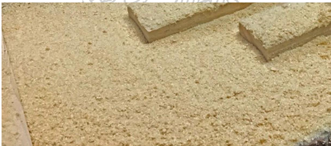
ภาพที่ 32 จี้เลื่อยละเอียดและจี้เลื่อยหยาบที่ใช้ในการประสานไม้
