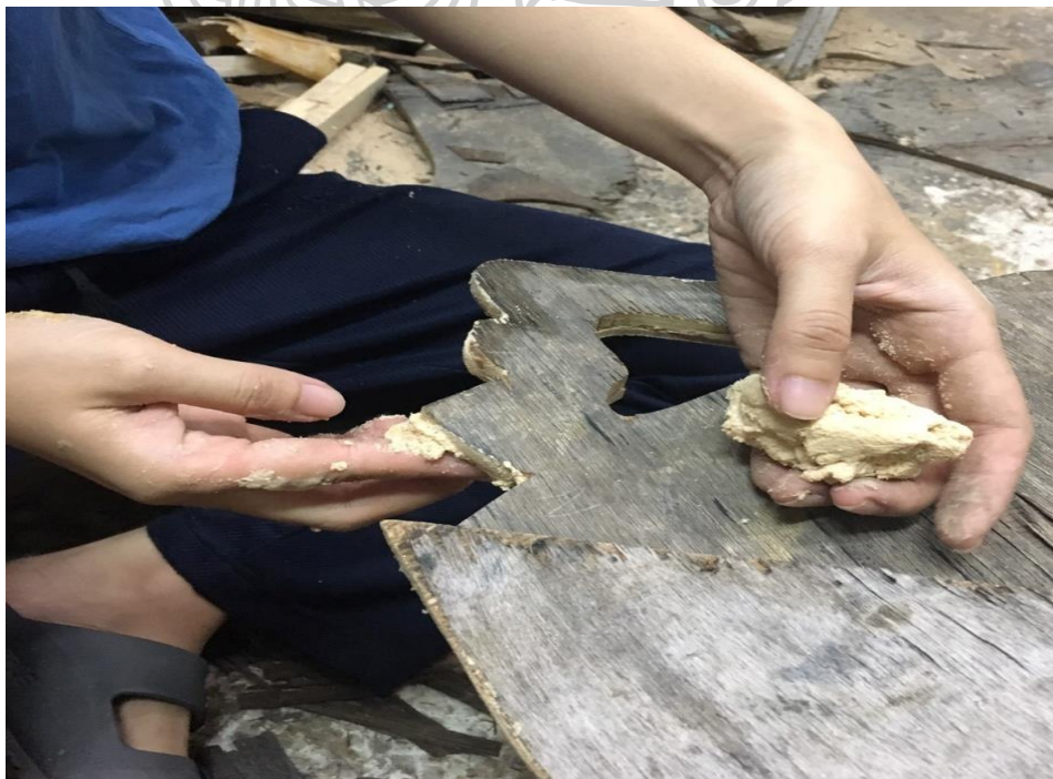
ภาพที่ 49 ภาพการใช้ขี้เลื่อยเพื่อเก็บรายละเอียดในผลงาน
