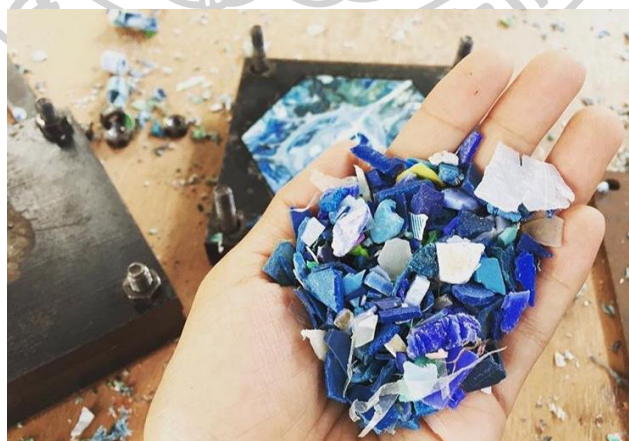
ภาพที่ 63 ภาพขั้นตอนการทดลองสร้างสรรค์ผลงานจากฝาขวดพลาสติกโดยคุณศุภฤกษ์ ทหาราศรี ขั้นตอนที่ 1 ตัด แบ่งชิ้นส่วนจากพลาสติกเป็นชิ้นเล็กๆ และแบ่งแยกตามโทนสี เพื่อสะดวก ในการสร้างสรรค์ผลงาน
