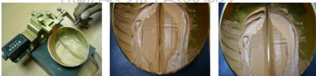
ภาพที่ 7-9 รูปภาพแสดงการทดสอบความเหนียวของดินโดยวิธี Atterberg's limits ปี 2561 ถ่ายโดยผู้วิจัย
