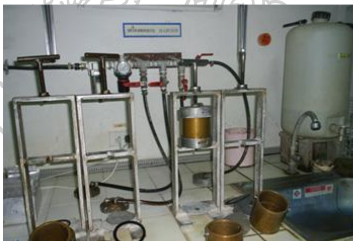
ภาพที่ 3 รูปภาพการหาอัตราการหล่อแบบโดยใช้เครื่อง Baroid
