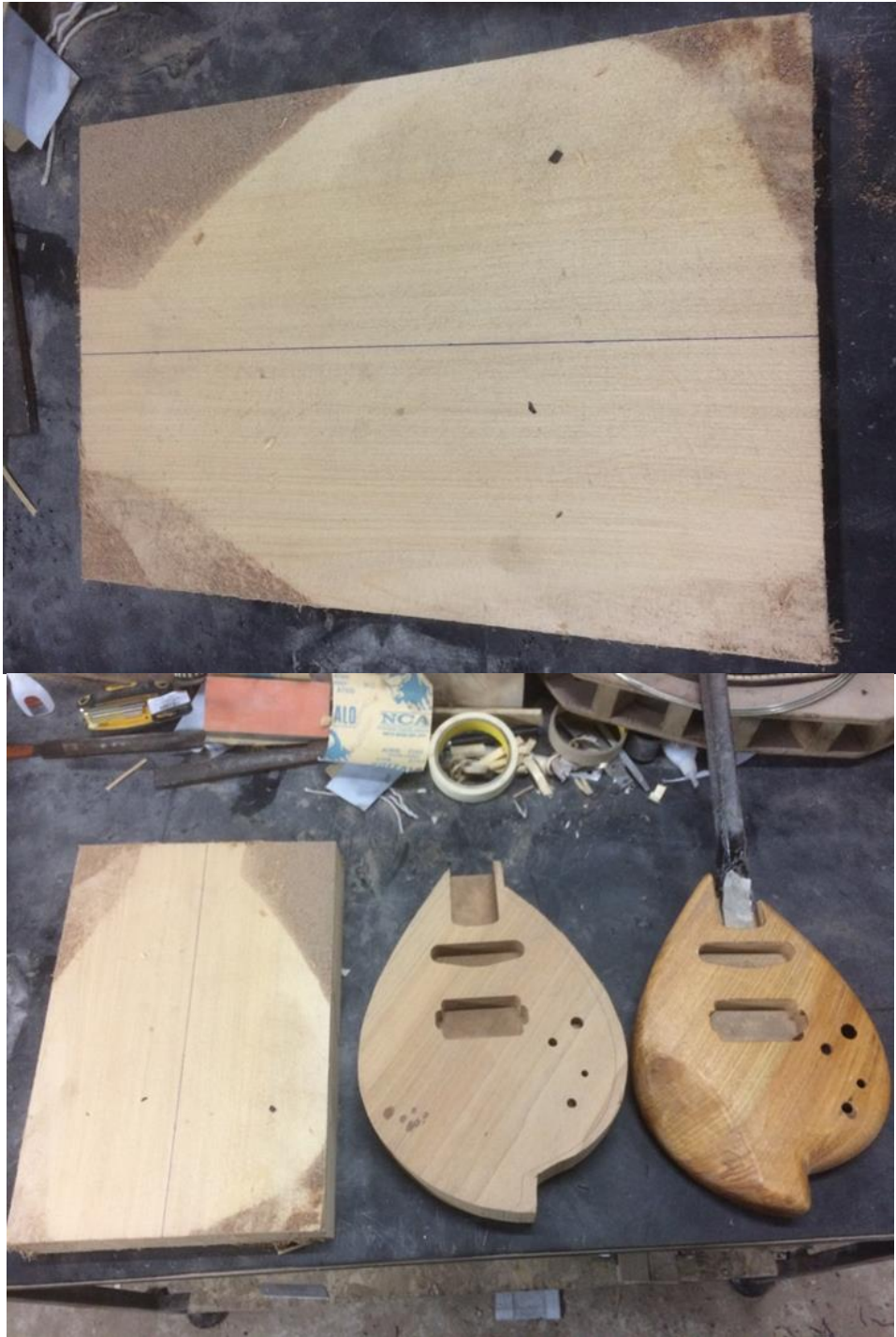
ภาพที่ 131 ไม้ที่ใช้ทำพิณไฟฟ้าโมดิ
