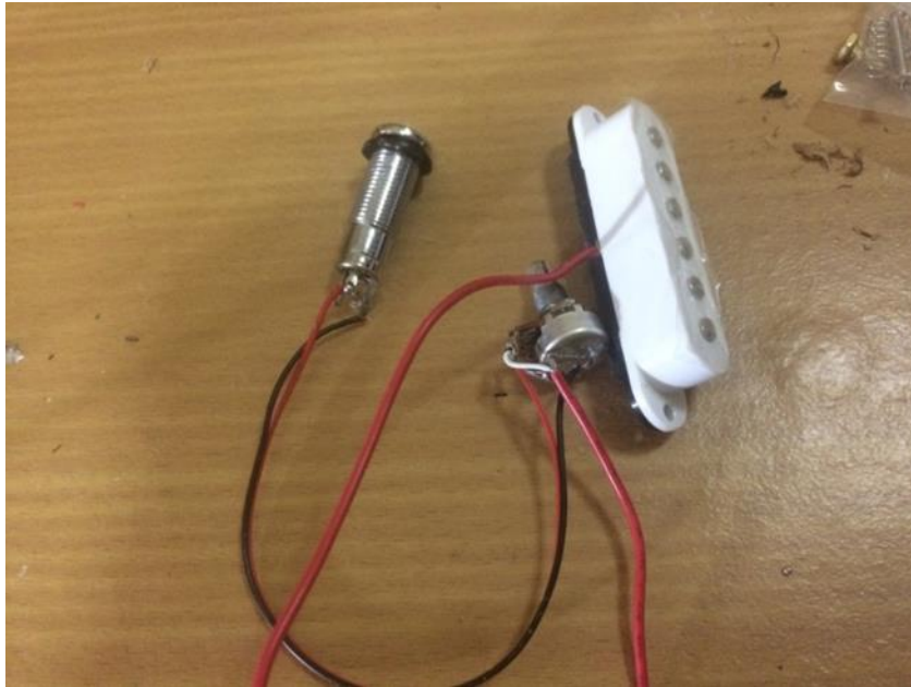
ภาพที่ 80 ปิ๊กอัพแบบซิงเกิ้ลคอยล์ (single coil)
