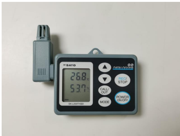
ภาพที่ 6 อุปกรณ์บันทึกข้อมูลอุณหภูมิและความชื้นแบบต่อเนื่อง (data logger) (ถ่ายโดยผู้ศึกษา เมื่อวันที่ 18 ตุลาคม 2562)
