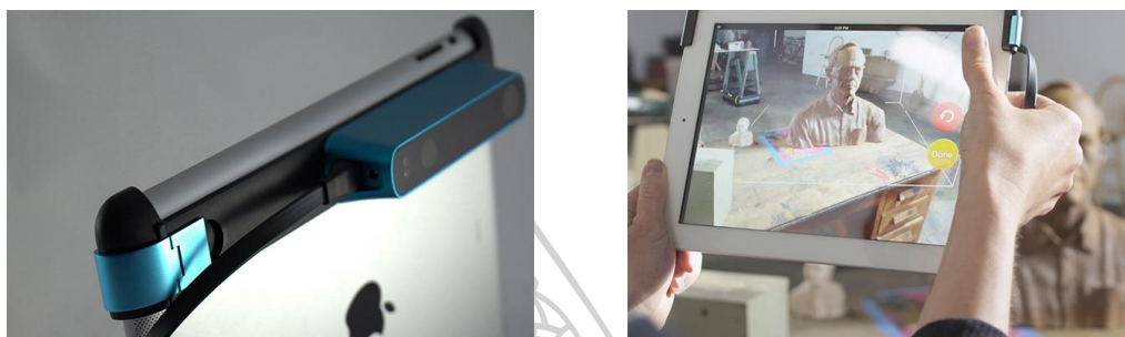
ภาพที่ 104 อุปกรณ์ Structure Sensor ที่ใช้ทำงานร่วมกับ iPad เพื่อทำการสแกนสามมิติ ที่มา : https://www.hardwarezone.com.my/tech-news-structure-sensor-allows-your-ipad-scan-anything-3d
