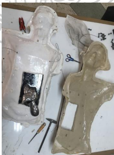
ภาพที่ 51 ขั้นตอนการแกะแม่พิมพ์ยางซิลิโคน
