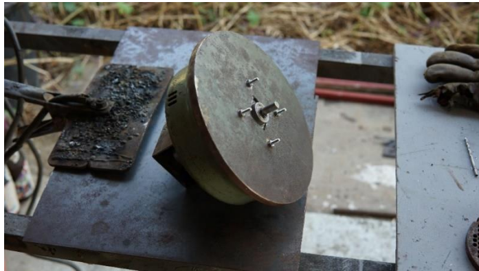
ภาพที่ 65 มอเตอร์ใช้ในการเคลื่อนไหวลักษณะลอคชัก
