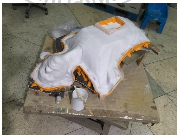
ภาพที่ 46 ขั้นตอนการทำแม่พิมพ์ยางซิลิโคน
