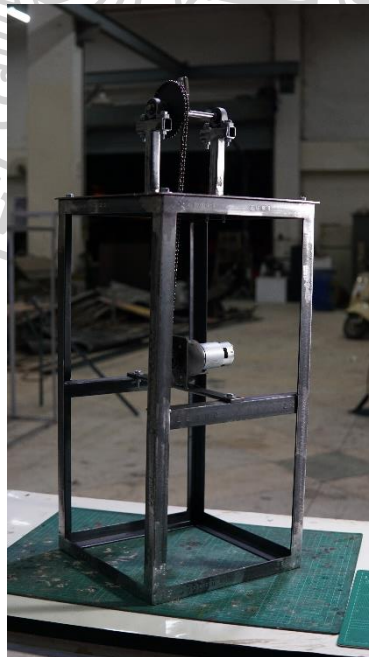
ภาพที่ 76 ติดตั้งระบบขับเคลื่อนมอเตอร์ DC
