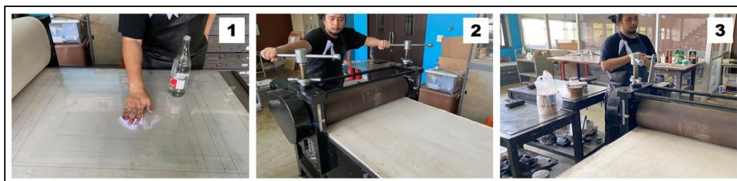
ภาพที่ 35 ภาพแสดงขั้นตอนการเตรียมแท่นพิมพ์
