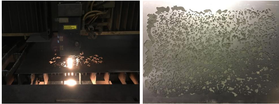
ภาพที่ 46 (ซ้าย) กระบวนการฉลุแผ่นสแตนเลสด้วยการตัดเลเซอร์ (Laser cutting)
