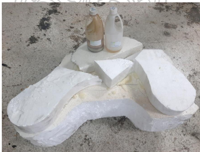
ภาพที่ 25 วิธีการเชื่อมก้อนโฟมด้วยยูรีเทนโฟมเพื่อเพิ่มขนาดของโครงสร้าง
