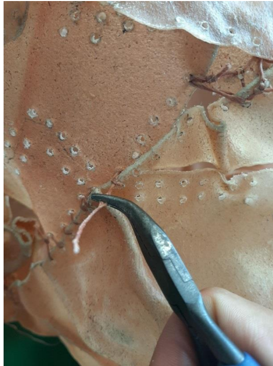
ภาพที่ 37 ใช้คีมปากโค้งช่วยดึงเชือกเทียบให้แน่น
