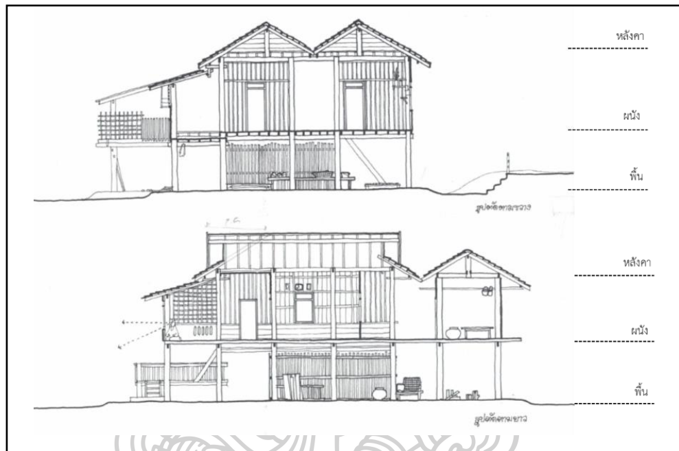
ภาพที่ 219 แสดงตัวอย่างโครงสร้างของกลุ่มเรือนไม้พื้นถิ่นแม่แจ่มที่พบในพื้นที่ศึกษา
