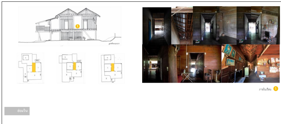
ภาพที่ 204 แสดงลักษณะ และการใช้พื้นที่ของ “อ้อมริน” ในเรือนแม่แจ่ม
