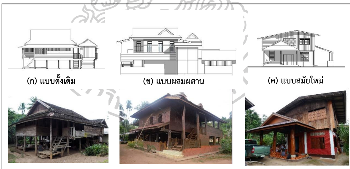
ภาพที่ 69 แสดงลักษณะของเรือนแม่แจ่มที่ทั้ง 3 ประเภท
