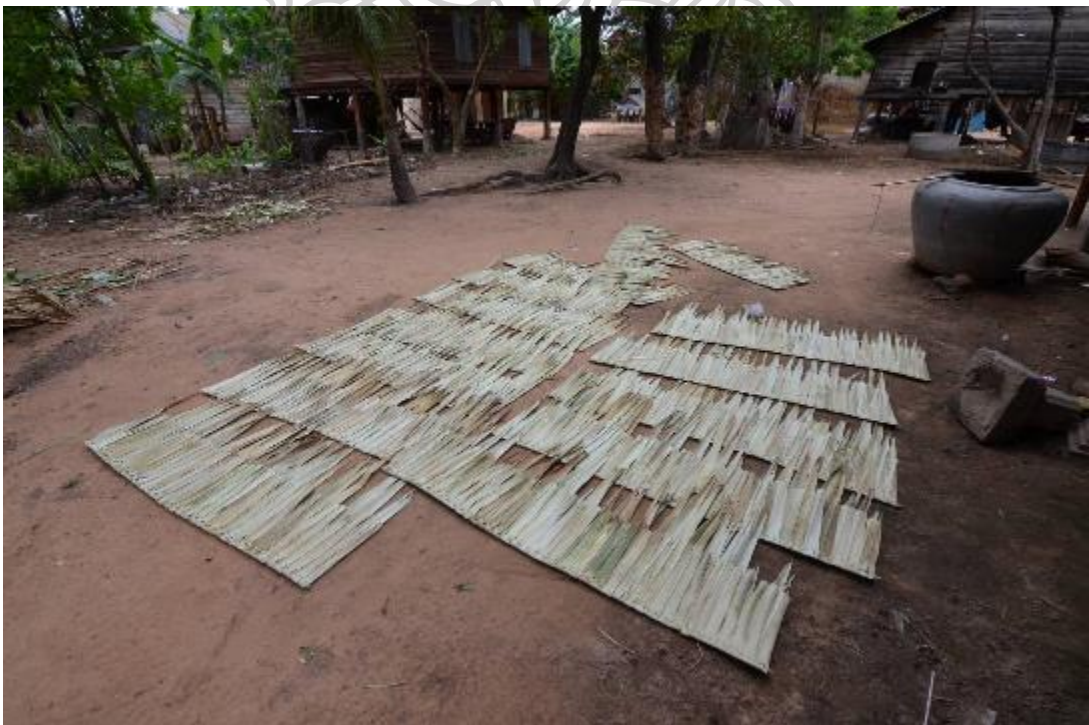
รูปที่ 39 ใบตาลที่ถูกนำมาเย็บเป็นตับ เพื่อใช้สำหรับมุงหลังคา
