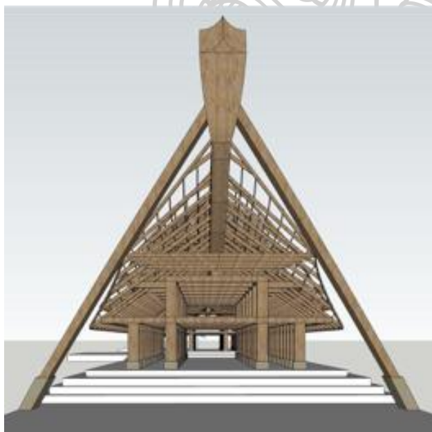
ภาพที่ 5.33 ภาพจำลอง 3 มิติ : แสดงงานออกแบบโครงสร้างหลังคาแทนค่าโครงสร้างเรือ 3
