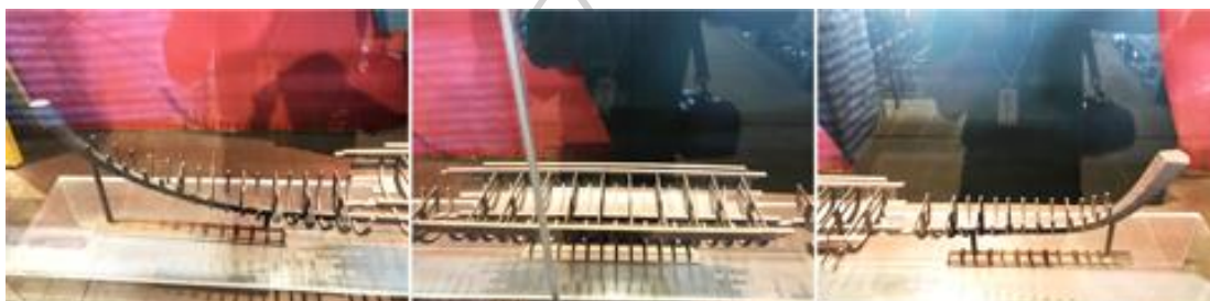
ภาพที่ 5.28 ภาพหุ่นจำลองโครงสร้างเรือพระราชพิธีแบบยาวตลอดลำเรือ จากพิพิธภัณฑ์เรือพระราชพิธีคลองบางกอกน้อย
