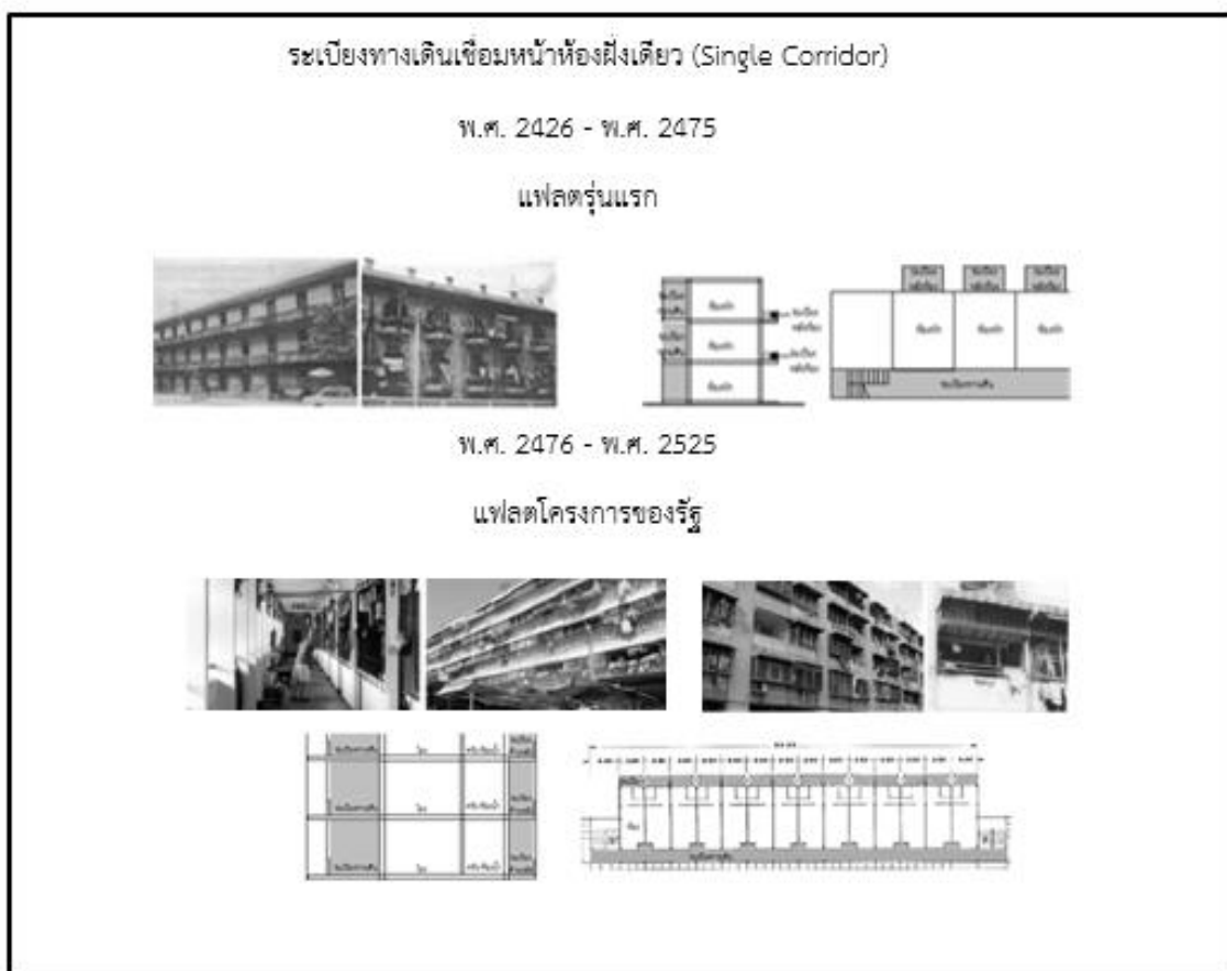
ภาพที่ 126 แสดงระเบียงอาคารอยู่อาศัยรวมหน่วย
