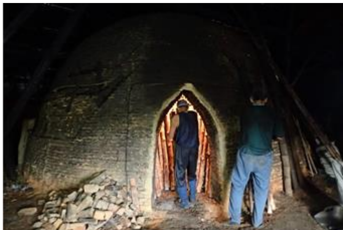
ภาพที่ 72 การตั้งไม้ในเตาเผาถ่านจะเว้นพื้นที่บริเวณทางเข้าเตาไว้เพื่อการใส่เชื้อไฟ
