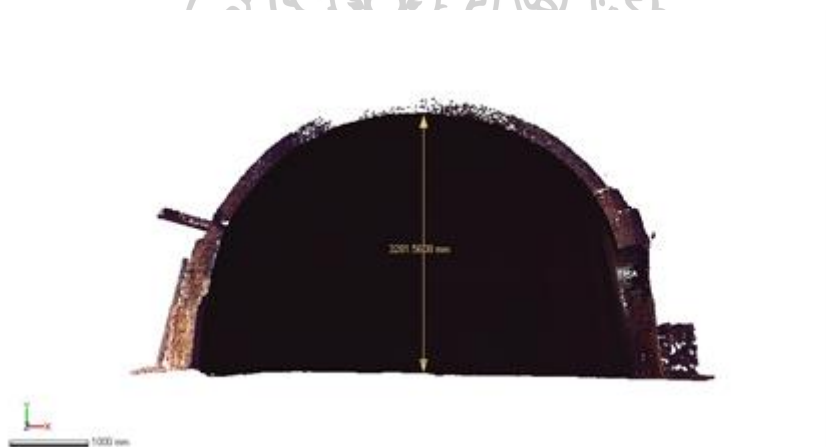
ภาพที่ 153 รูปตัดเตาเผาถ่าน จากการสแกน 3 มิติ ความสูงภายในเตาประมาณ 3.20 – 3.30 ม.
