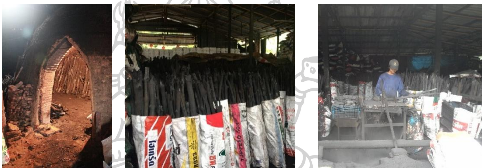
ภาพที่ 87 เมื่อได้เวลาทำการเปิดเตาล้ำเสียงถ่านออกมาจากเตา เข้าสู่ขั้นตอนการบรรจุใส่ถุง หรือตัดเป็นท่อนยาวท่อนละ 20-25 เซนติเมตร
