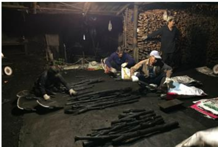
ภาพที่ 81 การเคาะหัวถ่าน แยกขนาด และบรรจุใส่ถุง
