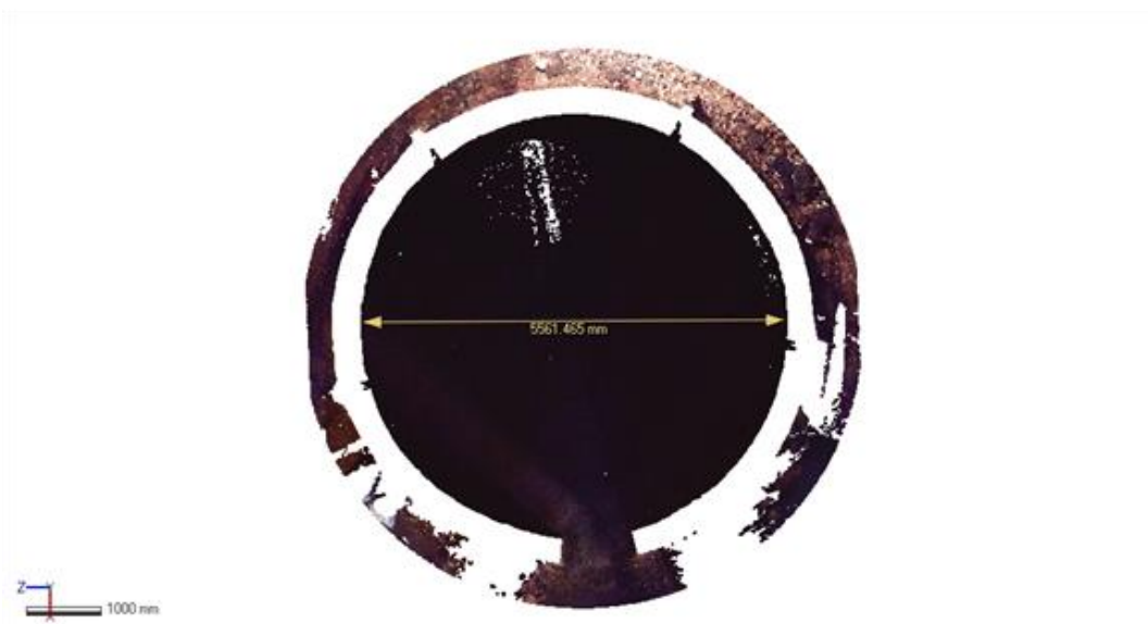
ภาพที่ 152 แพลนเตาเผาถ่าน จากการสแกน 3 มิติ ขนาดเส้นผ่าศูนย์กลางประมาณ 5.50 ม.
