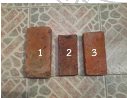
ภาพที่ 134 อิฐที่ใช้ในการก่อเตาเผาถ่าน หมายเลข 1 และ 2 ผลิตที่อำเภอสามโคก จังหวัดปทุมธานี หมายเลข 3 ผลิตที่จังหวัดพระนครศรีอยุธยา
