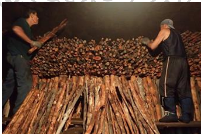
ภาพที่ 71 ไม้หลายขนาดใหญ่ตั้งอยู่ด้านล่าง (เรียกว่า ไม้ตั้ง) ไม้หลายขนาดเล็กซ้อนอยู่ด้านบน (เรียกว่า ไม้ซ้อน)
