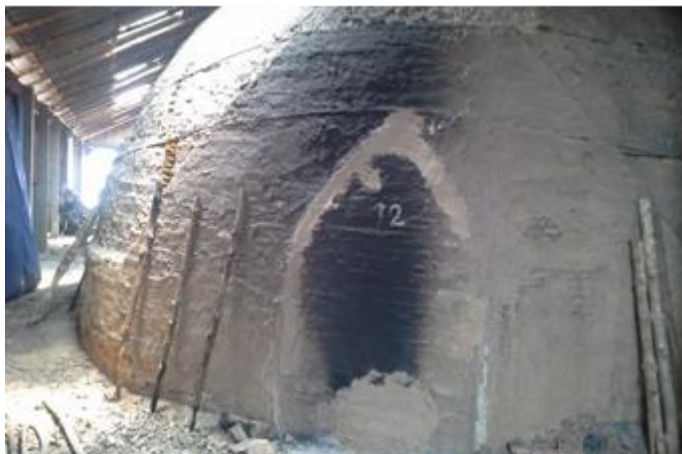
ภาพที่ 77 การปิดหน้าเตาจะกระทำเมื่อใช้ผู้พิจารณาว่าไม้หลาได้กลายสภาพเป็นถ่านแล้ว
