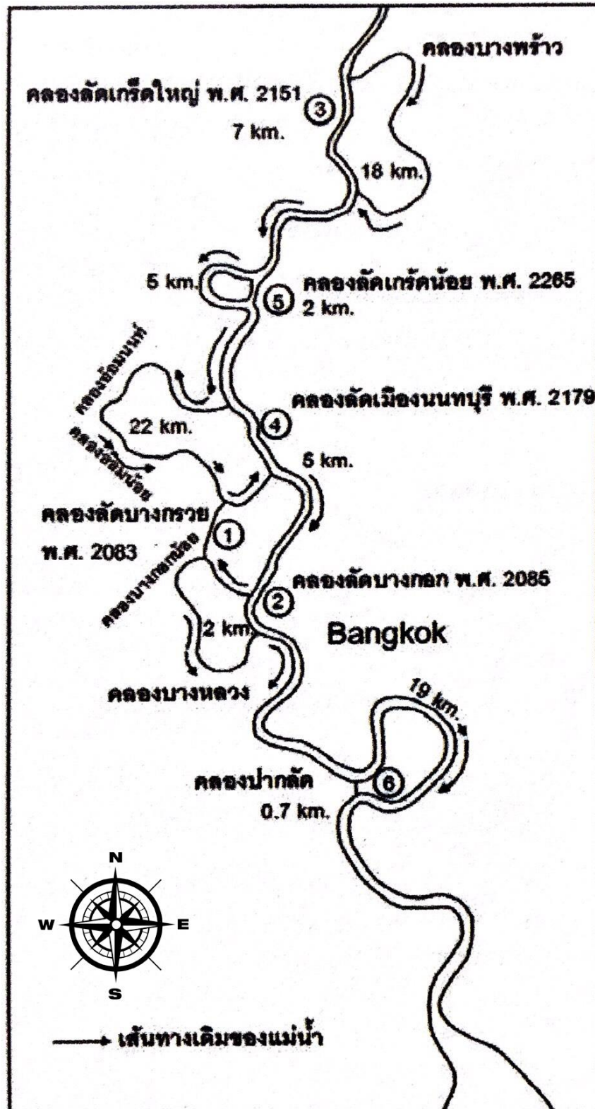
ภาพที่ 12 โครงข่ายคลองลัดที่ถูกขุดในแม่น้ำเจ้าพระยาตั้งแต่อดีตจนถึงปัจจุบัน ที่มา: Van Beek (1995)
