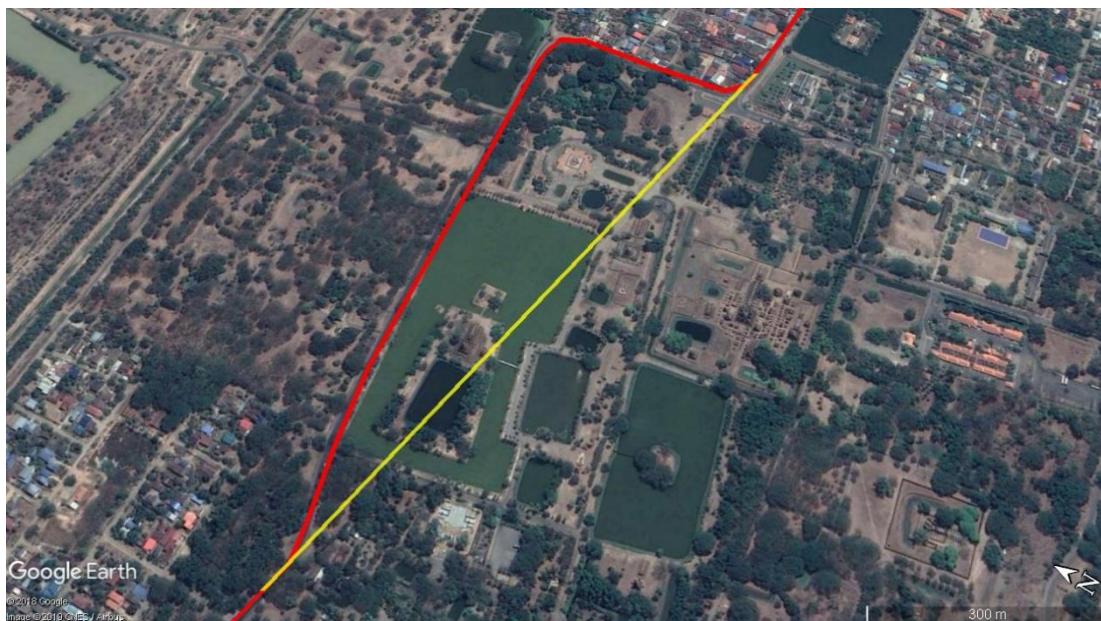
ภาพที่ 10 แนวทางหลวงแผ่นดินสายสุโขทัย-ตากที่ตัดผ่านภายในเขตกำแพงเมืองสุโขทัย (เส้นสีเหลือง) กับสายใหม่ที่ปรับปรุงจากเดิม (เส้นสีแดง)
