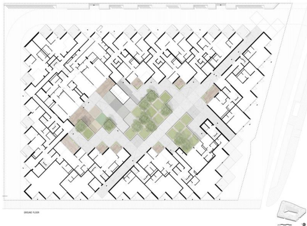
ภาพที่ 78 ลักษณะของพื้นที่วางแบบพิกัด (Grid Organization)
