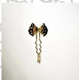
ภาพที่ 108 แสดงชิ้นงานทองเหลืองหลังชุบทองเรียบร้อย
