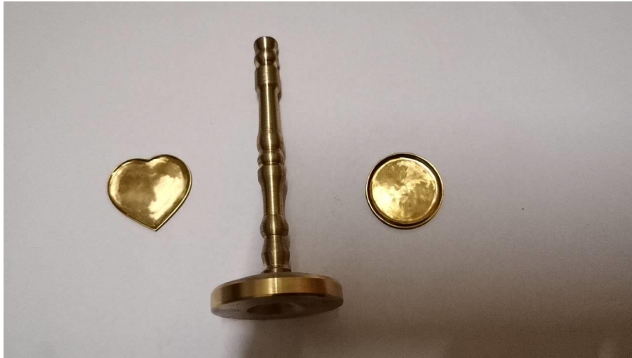
ภาพที่ 70 เคาะทองเหลืองขึ้นมือตามรูปแบบ (2)
