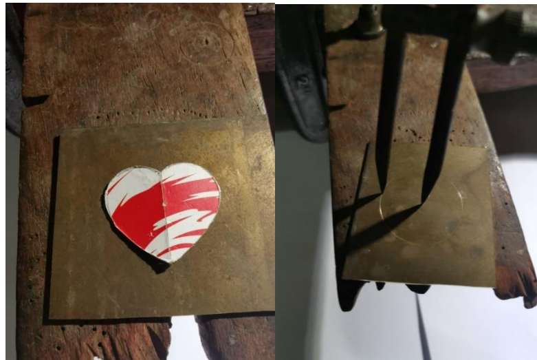
ภาพที่ 68 ฉลุทองเหลืองตามรูปแบบที่ต้องการ
