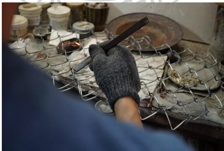
ภาพที่ 81 เชื่อมรอยต่อและลบคมของเหล็กตัด
