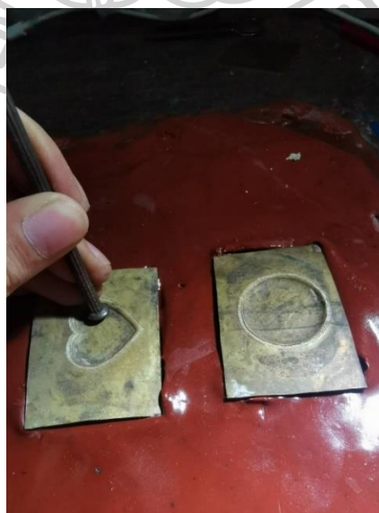
ภาพที่ 69 เคาะทองเหลืองขึ้นมือตามรูปแบบ (1)
