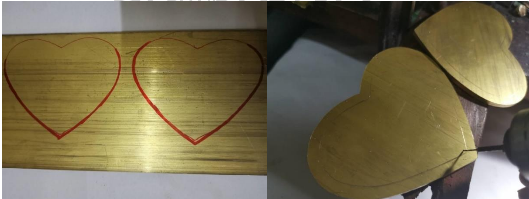
ภาพที่ 75 วาดแบบแผ่นทองเหลืองและตัดตามรูปทรง
