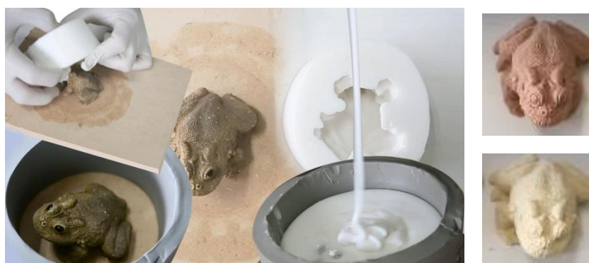
ภาพที่ 19 การทำแม่พิมพ์ยางซิลิโคนหน้าเดียว Pouring Block Mold
