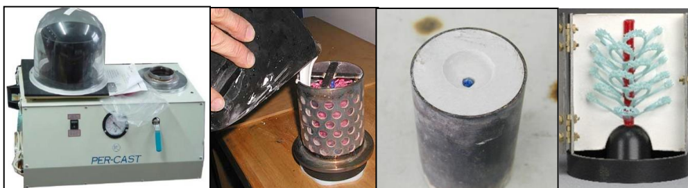
ภาพที่ 9 เครื่องดูดสุญญากาศ การเทปูน เบ้าปูนหล่อ สภาพต้นเทียนภายในเบ้าปูน ที่มา : Pathamaphorn Praphitphongwanit, “Jewelry Making Process” (Material and Process in Jewelry Production 2 Department of Jewelry Design, Faculty of Decorative Arts, Silpakorn University, 2011)
