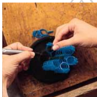
ภาพที่ 8 การติดต้นเทียน และต้นเทียนที่เสร็จเรียบร้อยแล้ว ที่มา : เอกสิทธิ์ นิสารัตนพรวัน, “เทคโนโลยีโลหะและวัสดุที่เหมาะสมสำหรับอุตสาหกรรมอัญมณีและเครื่องประดับ” (ณ โรงแรม เฟลิกซ์ ริเวอร์แคว จ.กาญจนบุรี, 19 กรกฎาคม 2553 ).
