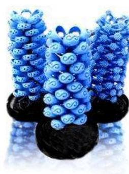
ภาพที่ 8 การติดต้นเทียน และต้นเทียนที่เสร็จเรียบร้อยแล้ว ที่มา : เอกสิทธิ์ นิสารัตนพรวัน, “เทคโนโลยีโลหะและวัสดุที่เหมาะสมสำหรับอุตสาหกรรมอัญมณีและเครื่องประดับ” (ณ โรงแรม เฟลิกซ์ ริเวอร์แคว จ.กาญจนบุรี, 19 กรกฎาคม 2553 ).
