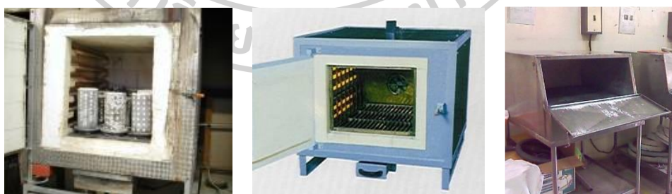
ภาพที่ 10 การไล่เทียนอบแห้ง เตาอบปูนด้วยก๊าซ การไล่เทียนด้วยไอน้ำ ที่มา: เอกสิทธิ์ นิสารัตนพรวัน, “เทคโนโลยีโลหะและวัสดุที่เหมาะสมสำหรับอุตสาหกรรมอัญมณีและเครื่องประดับ” (ณ โรงแรม เฟลิกซ์ ริเวอร์แคว จ.กาญจนบุรี, 19 กรกฎาคม 2553)
