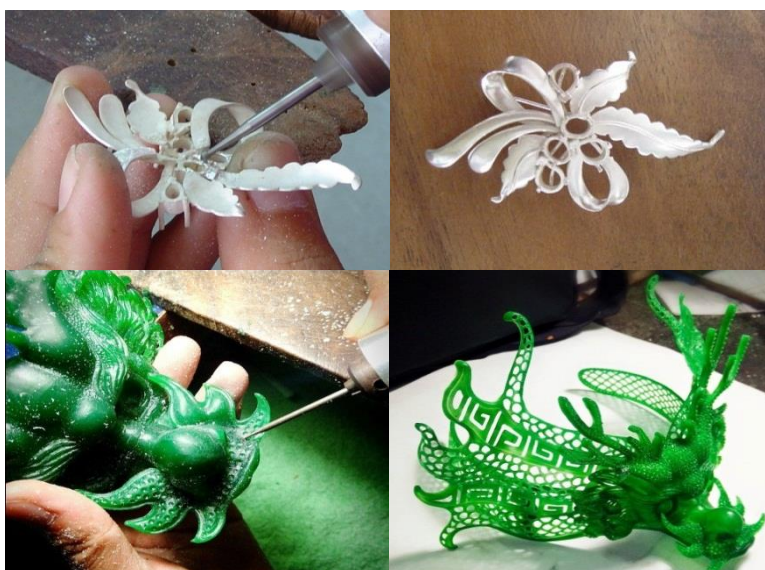
ภาพที่ 4 การขึ้นแม่พิมพ์โลหะด้วยมือ และการขึ้นแม่พิมพ์แว็กซ์ด้วยมือ
