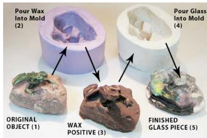
ภาพที่ 20 Stages of the Lost Wax Process for molding glass.
