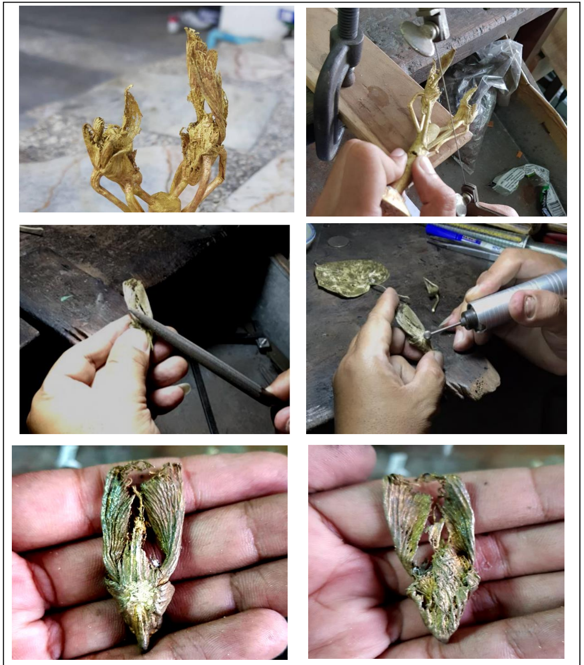
ภาพที่ 52 การตัดทางเดินน้ำโลหะและตกแต่ง
