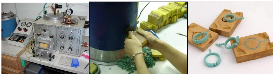
ภาพที่ 7 เครื่องฉีดเทียน การฉีดเทียน และแบบเทียน
