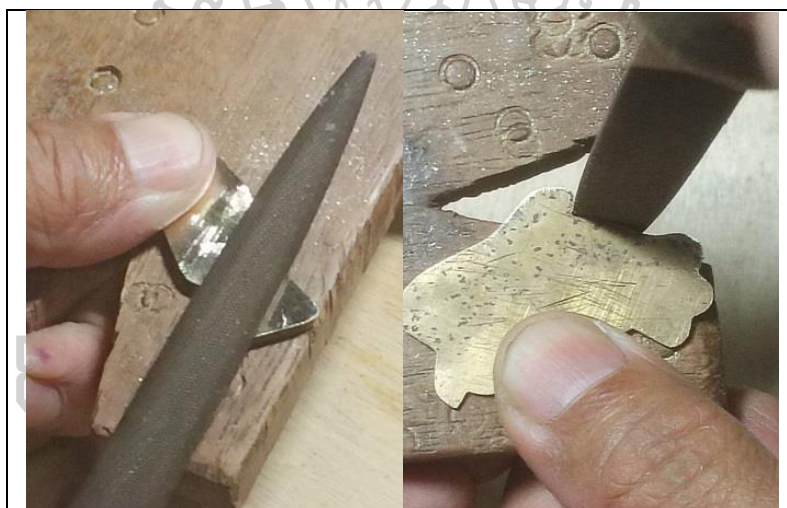
ภาพที่ 50 การขัดชิ้นงานเครื่องประดับด้วยตะไบ
