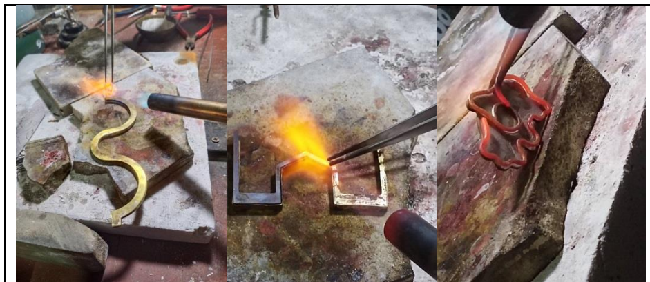
ภาพที่ 49 การเชื่อมชิ้นงานเครื่องประดับ
