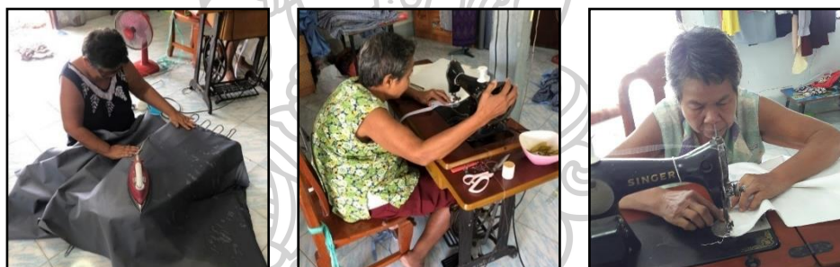
รูปที่ 34 ขั้นตอนการประกอบชิ้นส่วนผ้าคลุมโครงสร้างตู้เสื้อผ้า ช่างผู้ชำนาญการเย็บประกอบชิ้นส่วนผ้าส่วนต่าง ๆ ตามขนาด และรูปทรงที่ได้ออกแบบไว้เข้าด้วยกัน
