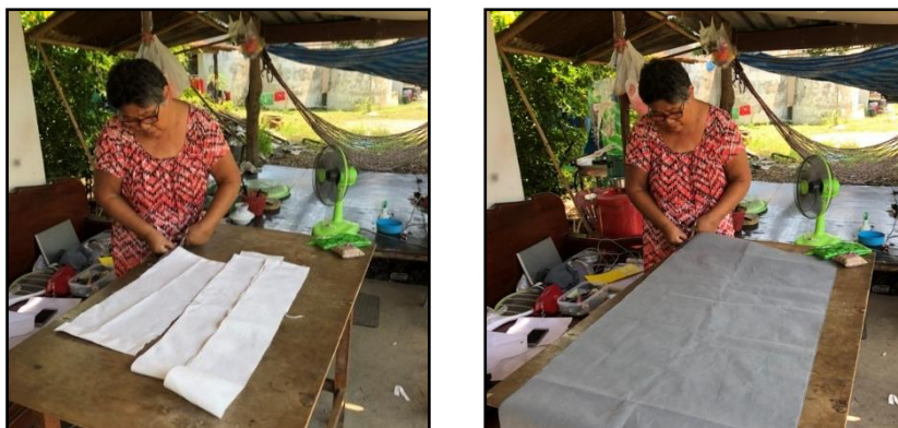
รูปที่ 33 ขั้นตอนการเตรียมชิ้นส่วนผ้าคลุมโครงสร้างตู้เสื้อผ้า เริ่มจากช่างผู้ชำนาญการใช้เครื่องมือตัดผ้าเป็นชิ้นส่วนต่าง ๆ ตามขนาด และรูปทรงที่ได้ออกแบบไว้
