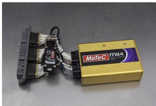
ภาพที่ 18 กล่องควบคุมระบบต่าง ๆ ของรถ หรือ ECU
