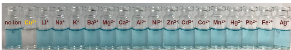
ภาพที่ 45 การเปลี่ยนแปลงสีของเซ็นเซอร์ Cy7C3 ในสารละลาย HEPES buffer:CH 3 CN (3:7 v/v) ก่อนและหลังเติมไอออนทองแดงและไอออนรบกวนอื่น ๆ
