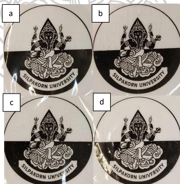
รูปที่ 36 แสดงลักษณะทางกายภาพของฟิล์มคอมโพสิตระหว่าง PVA และเส้นใยที่ผ่านการปั่นที่ 1600 rpm และ acid hydrolysis ที่ 45 องศาเซลเซียส 45 นาที ที่ a) 1, b) 3, c) 5 และ d) 7 phr
