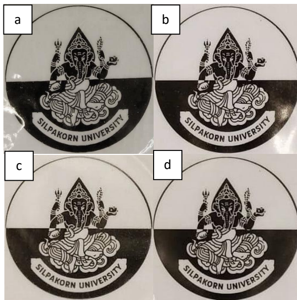
รูปที่ 37 แสดงลักษณะทางกายภาพของฟิล์มคอมโพสิตระหว่าง PVA และเส้นใยที่ผ่านการปั่นที่ 1600 rpm และ acid hydrolysis ที่ 45 องศาเซลเซียส 90 นาที ที่ a) 1, b) 3, c) 5 และ d) 7 phr
