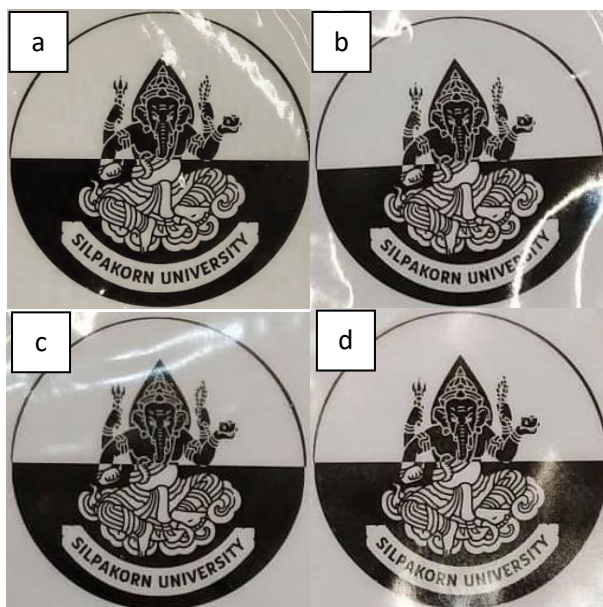
รูปที่ 33 แสดงลักษณะทางกายภาพของฟิล์มคอมโพสิตระหว่าง PVA และเส้นใยที่ผ่านการปั่นที่ 1600 rpm และ acid hydrolysis ที่ 45 องศาเซลเซียส 45 นาที ที่ a) 1, b) 3, c) 5 และ d) 7 phr
