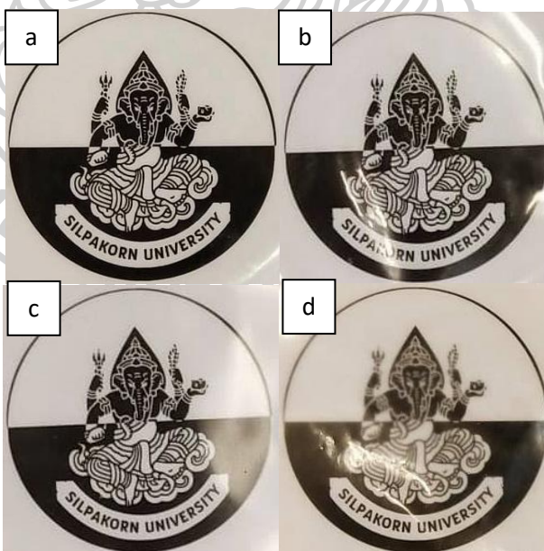
รูปที่ 34 แสดงลักษณะทางกายภาพของฟิล์มคอมโพสิตระหว่าง PVA และเส้นใยที่ผ่านการปั่นที่ 1600 rpm และ acid hydrolysis ที่ 60 องศาเซลเซียส 45 นาที ที่ a) 1, b) 3, c) 5 และ d) 7 phr
