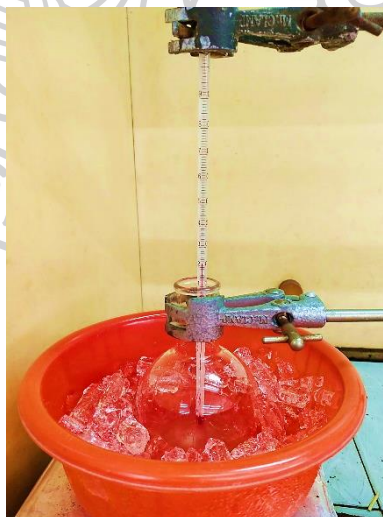
รูปที่ 23 การไฮโดรไลซิสไมโครไฟเบอร์ด้วยกรดซัลฟิวริก
