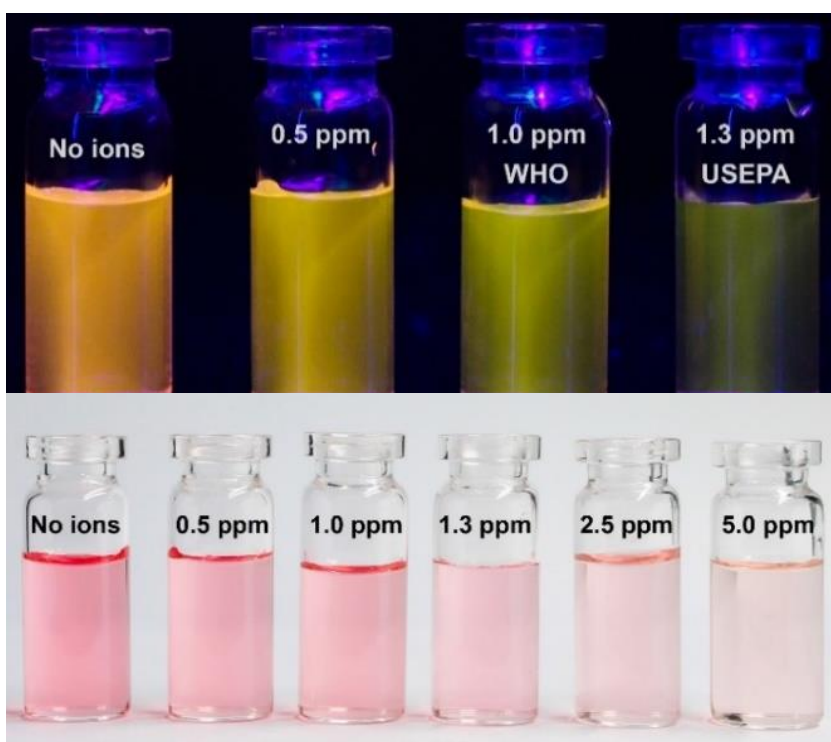
ภาพที่ 52 ภาพถ่ายการเปลี่ยนสีของสารละลายเซ็นเซอร์ N1102 ในภาวะที่มีไอออนทองแดงที่ความเข้มข้นต่างๆ ภายใต้แสงอัลตราไวโอเล็ตและแสงไฟปกติ
