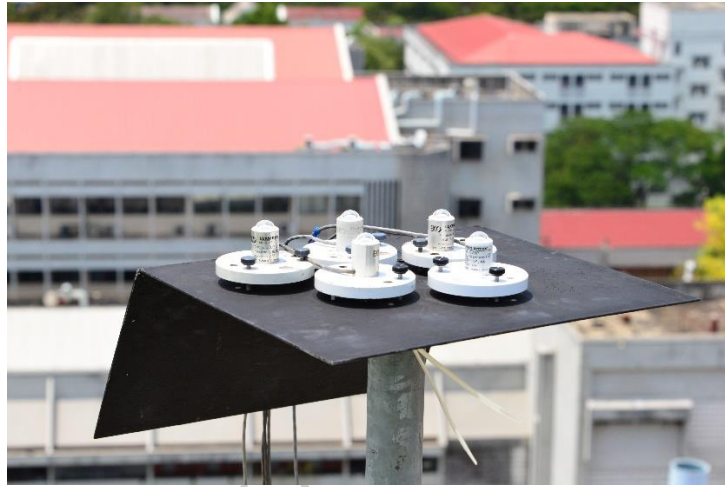
รูปที่ 3.7 การสอบเทียบเครื่องลักซ์มิเตอร์ที่มหาวิทยาลัยศิลปากร จังหวัดนครปฐม
