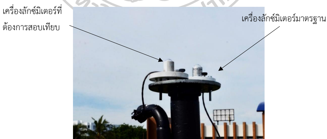
รูปที่ 3.4 การสอบเทียบเครื่องลักซ์มิเตอร์ของสถานีสงขลา
