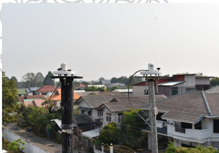
รูปที่ 3.6 การสอบเทียบเครื่องลักซ์มิเตอร์ที่ศูนย์อุตุนิยมวิทยาภาคตะวันออกเฉียงเหนือ จังหวัดอุบลราชธานี
