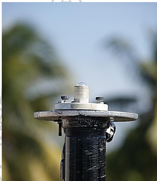
รูปที่ 2.10 เครื่องวัดความเข้มของแสงสว่างหรือ ลักซ์มิเตอร์ (luxmeter)
