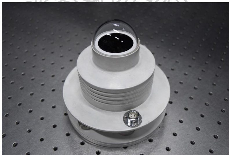
รูปที่ 65 เครื่องวัดรังสีอัลตราไวโอเล็ตที่มีผลต่อผิวหนังมนุษย์ รุ่น 501A ที่ผลิตโดยบริษัท Solar Light
