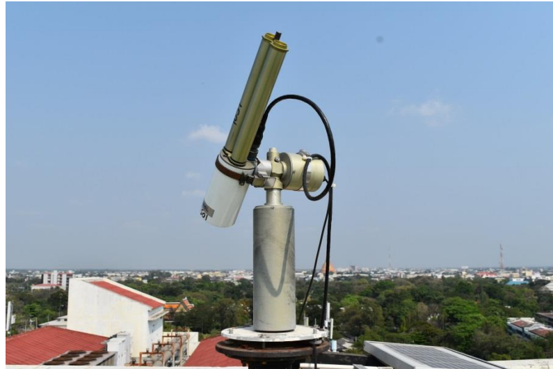
รูปที่ 27 เครื่อง sunphotometer ที่ตาดฟ้าชั้น 11 อาคารวิทยาศาสตร์ 1 คณะวิทยาศาสตร์ มหาวิทยาลัยศิลปากร จังหวัดนครปฐม
