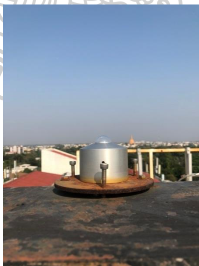
รูปที่ 8 เครื่องวัดสเปกตรัมรังสีอัลตราไวโอเล็ตรุ่น DMc 150 ที่ผลิตโดยบริษัท Bentham Instrument Ltd.
