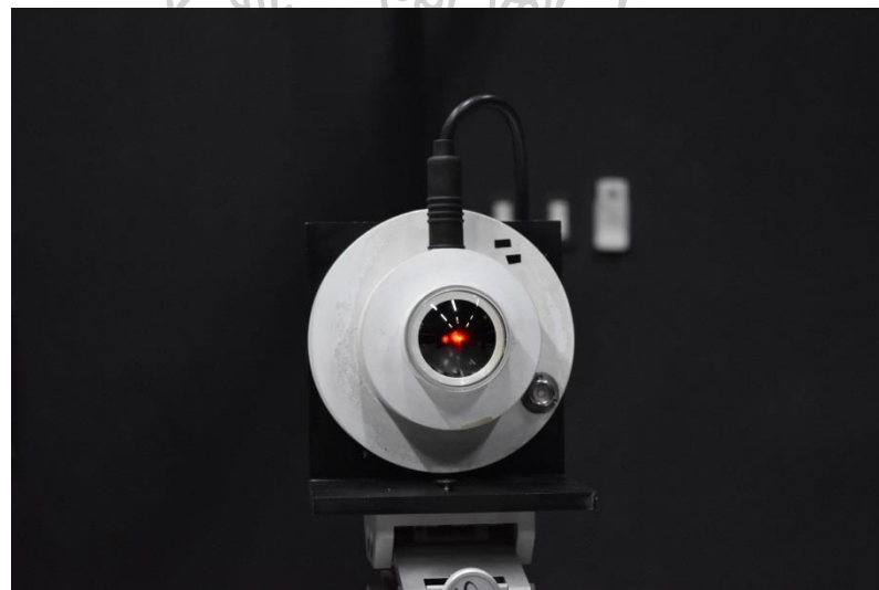
รูปที่ 74 ระดับเลเซอร์ฮีเลียมนีออนที่ตรงกับกึ่งกลางของหัววัดรังสีอัลตราไวโอเล็ต
