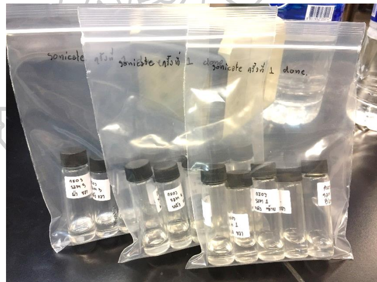
ภาพที่ 42 ตัวอย่างสารละลายเขม่าดินปืนที่ผ่านการสกัด และกรอง ก่อนนำไปวิเคราะห์ด้วย อุปกรณ์ตรวจวัดบนกระดาน และ IC
