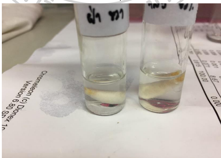
ภาพที่ 40 การเตรียมตัวอย่าง โดยแช่ด้านสำลีลงใน vial ที่มีน้ำปราศจากไอออน 2 mL
