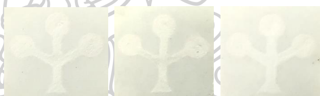
ภาพที่ 21 อุปกรณ์ตรวจวัดบนกระดาษที่ทดสอบกับสารละลายสารรบกวน
