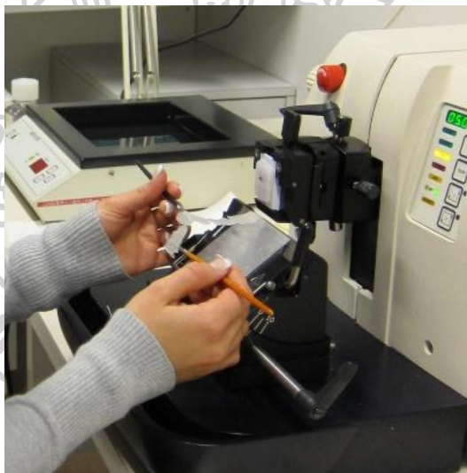
รูปภาพที่ 3 การการตัดบล็อกชิ้นเนื้อ (Sectioning) ด้วยเครื่องมือไมโครโทม (microtome)
