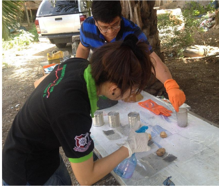
ภาพที่ 15 ภาพสเปรย์น้ำยาลงบนวัสดุที่จัดเรียงไว้หลังจากนำออกจากเตา
