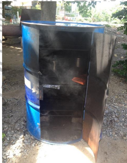
ภาพที่ 13 ภาพถัง B เมื่อเผาเสร็จแล้วพร้อมที่จะเอาวัสดุออกจากถัง
