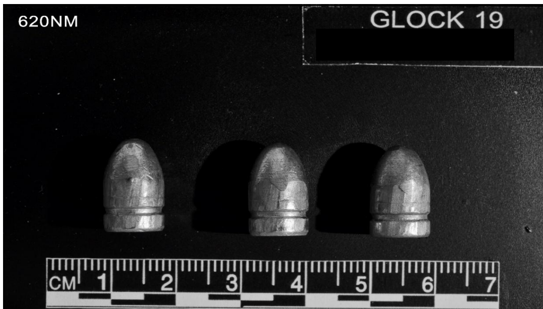
ภาพที่ 86 แสดงตัวอย่างภาพถ่ายลูกกระสุนปืนฯ ด้วยแสงความยาวคลื่น 620 นาโนเมตร แบบ Monotone
