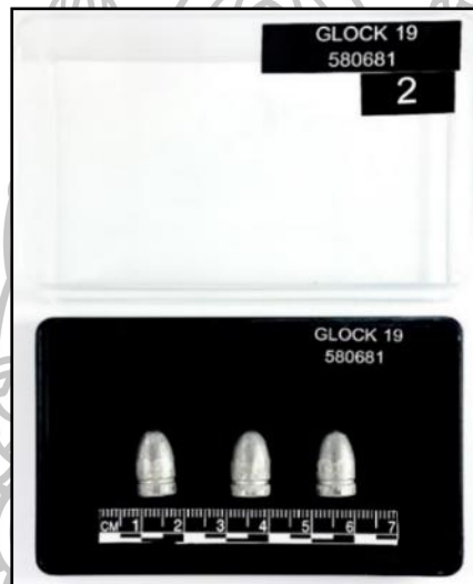
ภาพที่ 66 แสดงเฟลทพลาสติกสีดำชนิดต้าน ติดลูกกระสุนปืน เสกสอบขนาดและรายละเอียด พร้อมกล่องครอบชนิดใส
