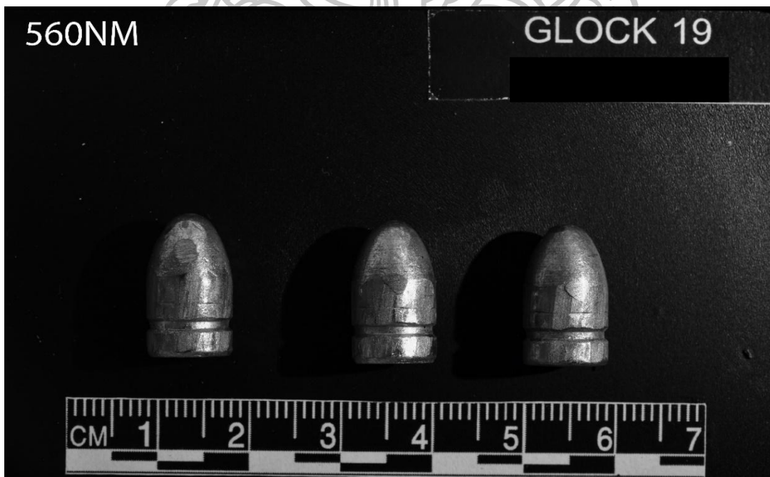
ภาพที่ 83 แสดงตัวอย่างภาพถ่ายลูกระสุนปืนฯ ด้วยแสงความยาวคลื่น 560 นาโนเมตร แบบ Monotone
