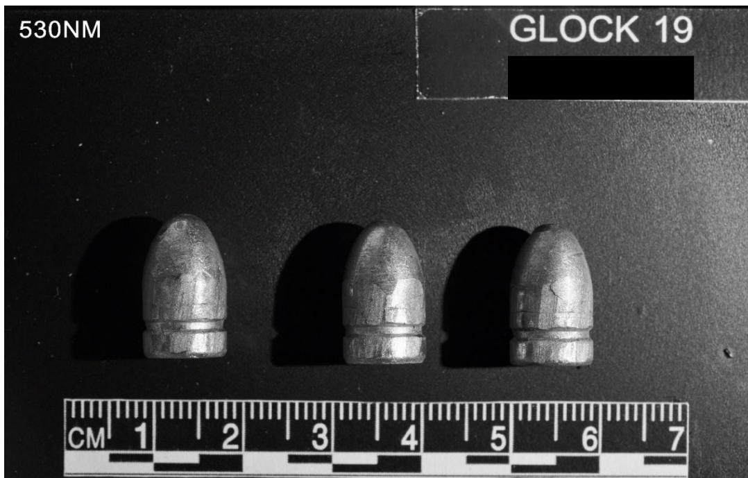
ภาพที่ 80 แสดงตัวอย่างภาพถ่ายลูกกระสุนปืนฯ ด้วยแสงความยาวคลื่น 530 นาโนเมตร แบบ Monotone
