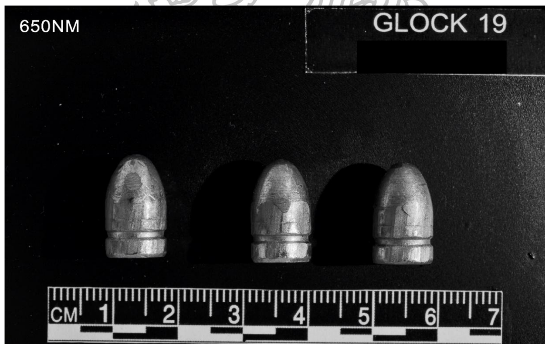
ภาพที่ 87 แสดงตัวอย่างภาพถ่ายลูกกระสุนปืนฯ ด้วยแสงความยาวคลื่น 650 นาโนเมตร แบบ Monotone
