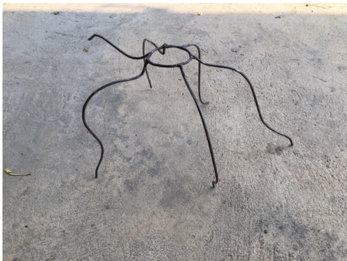
ภาพที่ 92 นำเหล็กเส้นมาดัดและเชื่อมเป็นส่วนขาของผลงานในทั้งส่วนของโครงสร้างและรายละเอียดของผลงาน
