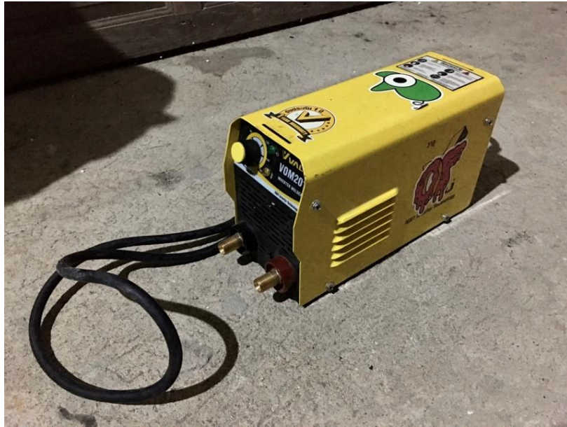
ภาพที่ 68 ตู้เชื่อมเหล็กเพื่อใช้เชื่อมเหล็กนำมาเป็นส่วนโครงสร้างของผลงานลอยตัว
