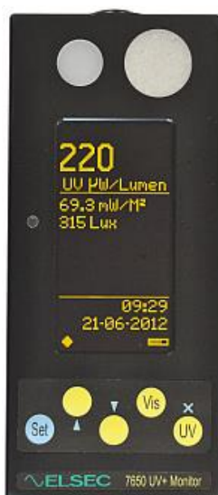
รูปที่ 4 อุปกรณ์ UV Monitor ELSEC 7650 ใช้ตรวจวัดปริมาณรังสีอัลตราไวโอเล็ต ที่มา: (Insitu Conservation, 2019)
