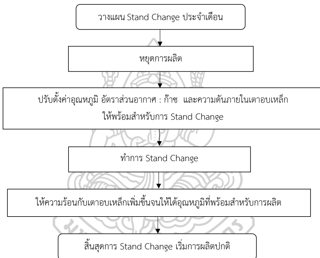
ภาพที่ 3.3 แผนผังขั้นตอนการเปลี่ยนลูกรีดก่อนการปรับปรุง
