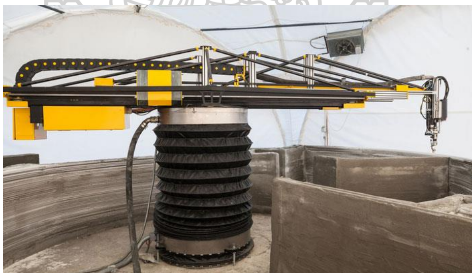
รูปที่ 13 ตัวอย่างเครื่องพิมพ์ 3 มิติในงานก่อสร้างของ Apis Cor
