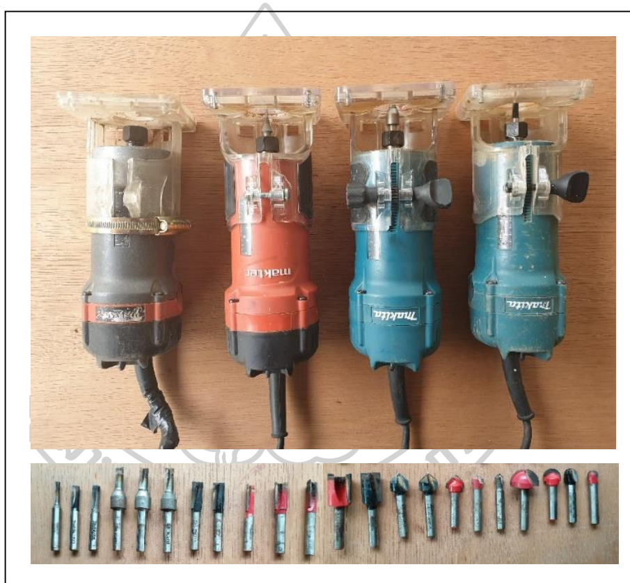
ภาพที่ 48 ทริมเมอร์เจาะไม้และดอกทริมเมอร์แบบต่างๆ
