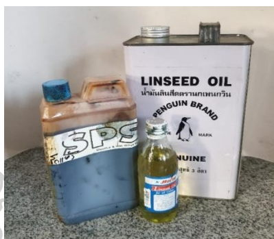
ภาพที่ 50 ตัวผสมหมักพืมน้ำมันลินสีดและน้ำมันชั๊กแห้ง
