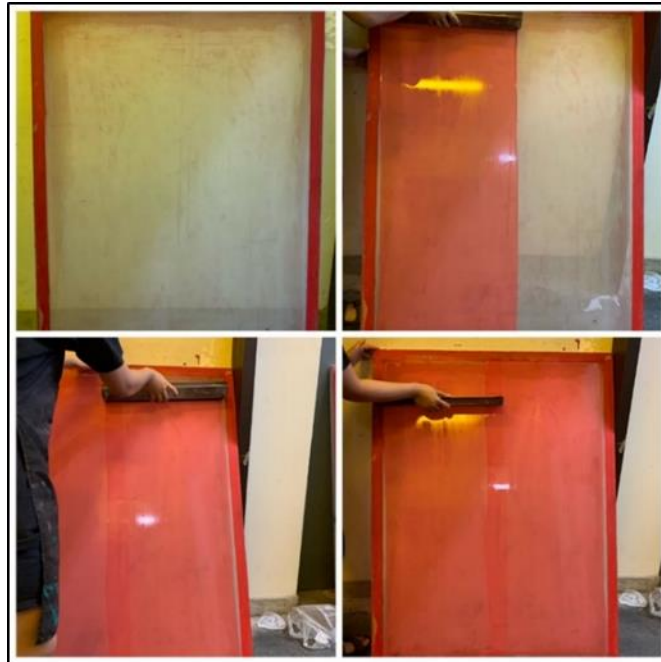
ภาพที่ 70 : ภาพแสดงการปาดกาวอัดสีชมพูลงบล็อกสกรีน
