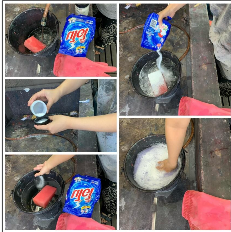
ภาพที่ 77 : ภาพแสดงการผสมผงล้างบล็อกกับผงซักฟอกลงในถังน้ำเพื่อทำความสะอาด
