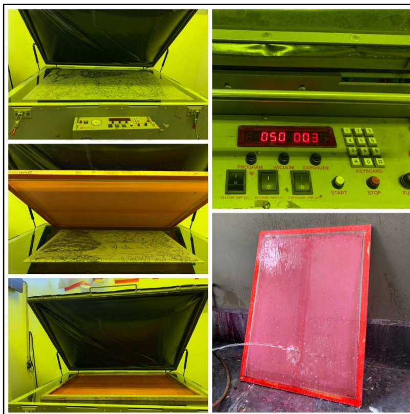
ภาพที่ 72 : ภาพแสดงการฉายแสงลงบล็อกสกรีน เพื่อใช้เป็นแม่พิมพ์
