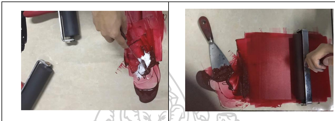
ภาพที่ 32 การผสมหมึกพิมพ์เพื่อใช้ในการพิมพ์ผลงาน
