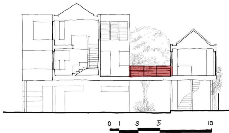
ภาพที่ 74 ระนาบทางตั้งแบบใช้ราวกันตกพร้อมกับตัวอาคารปรากฏในบ้านบนถนนพหลโยธิน
