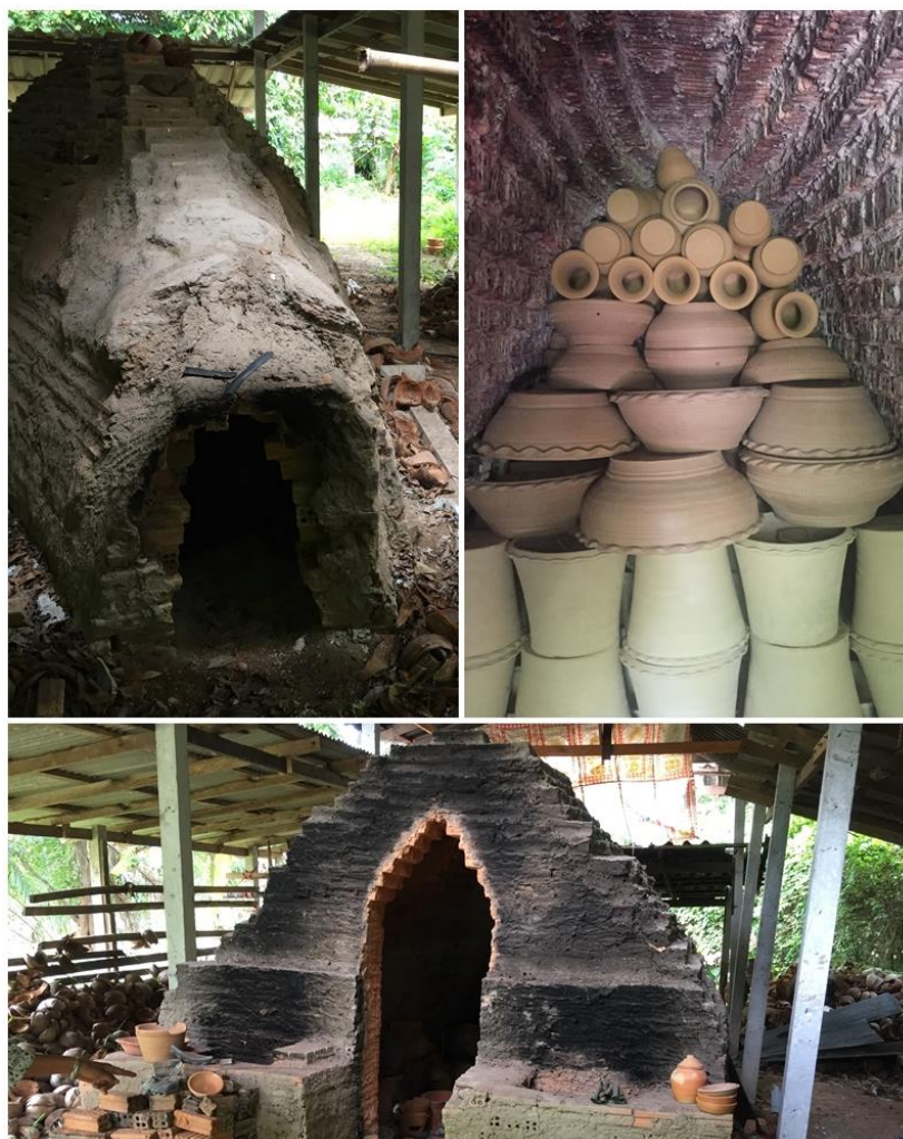
ภาพที่ 10 ภาพเตาเผาและการจัดวางชิ้นงานภายในเตา
