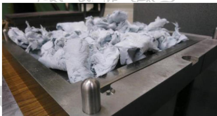
ภาพที่ 36 แม่พิมพ์เครื่องมืออุณหภูมิต่ำที่เต็มไปด้วยผ้าเคลือบหินเป็นชิ้นเล็ก ๆ พร้อมสำหรับการกด ความร้อน
