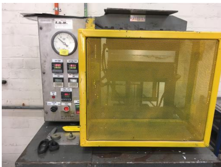
ภาพที่ 33 เครื่องบีบอัดความร้อน ที่มา: Vinyl Council Australia
