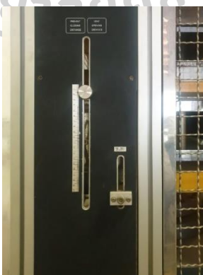
ภาพที่ 53 การปรับระยะห่างระหว่างแผ่นพิมพ์สำหรับ Pre-Heating ที่มา: (กัลย์สุดา ภูพันธ์เชือก, ประเทศไทย, 2563)
