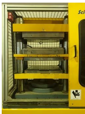
ภาพที่ 54 การนำแม่พิมพ์ลงจากแผ่นพิมพ์ร้อนลงมาที่แผ่นพิมพ์เย็นหลังจากอัดความร้อนแล้ว ที่มา: (กัลย์สุตา ภูพันธ์เชือก, ประเทศไทย, 2563)
