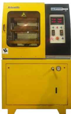
ภาพที่ 51 เครื่อง Labtech Compression Molding ที่มา: (กัลย์สุดา ภูพันธ์เชือก, ประเทศไทย, 2563)
