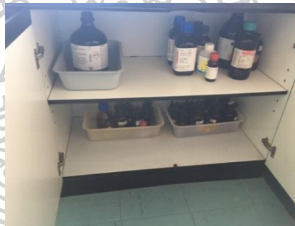
ข) มีภาชนะรองรับในการจัดเก็บสารเคมีประเภทกัดกร่อน
