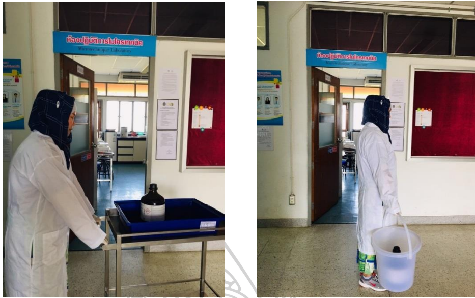
รูปที่ 4-12 ใช้ภาชนะรองรับสารเคมี และวัสดุดูดซับขณะเคลื่อนย้ายเคมีภายนอกห้องปฏิบัติการ
