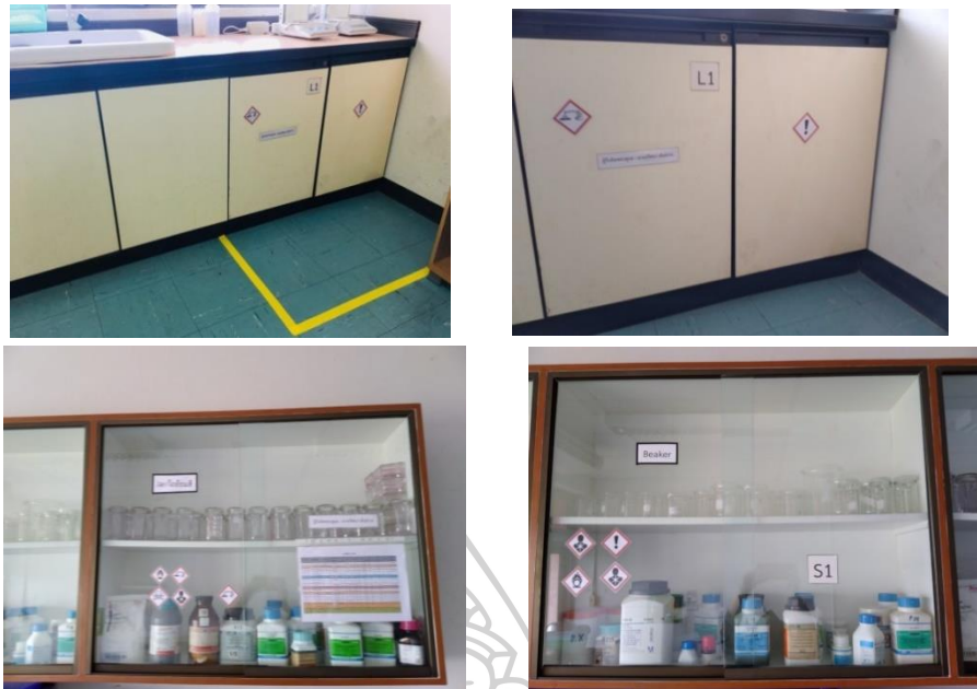
ก) ติดป้ายสัญลักษณ์ความเป็นอันตรายหน้าตู้เก็บสารเคมี
