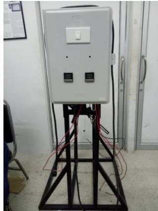
รูปที่ 48 แสดงฐานชุดทดลองและตู้ควบคุมการจ่ายกระแสไฟ
