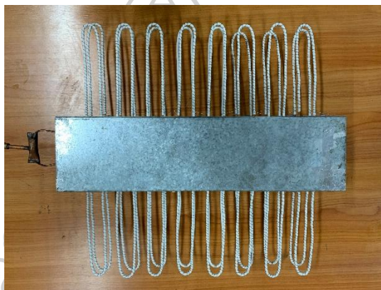
รูปที่ 44 แสดงการประกอบกล่องสังกะสี แผ่นสังกะสี และท่อทองแดง เชื่อมวาล์วศรเพื่อใช้เติมสารทำงาน และพันลวดนิกโครม
