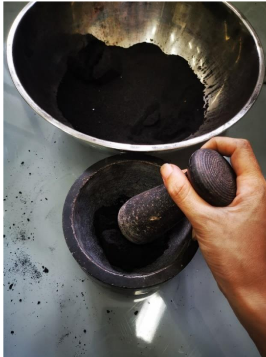
ภาพที่ 20 ภาพแสดงการนำถ่านกะลามาทำด้วยครก บด และร่อนให้ได้ความละเอียดตามที่ต้องการ
