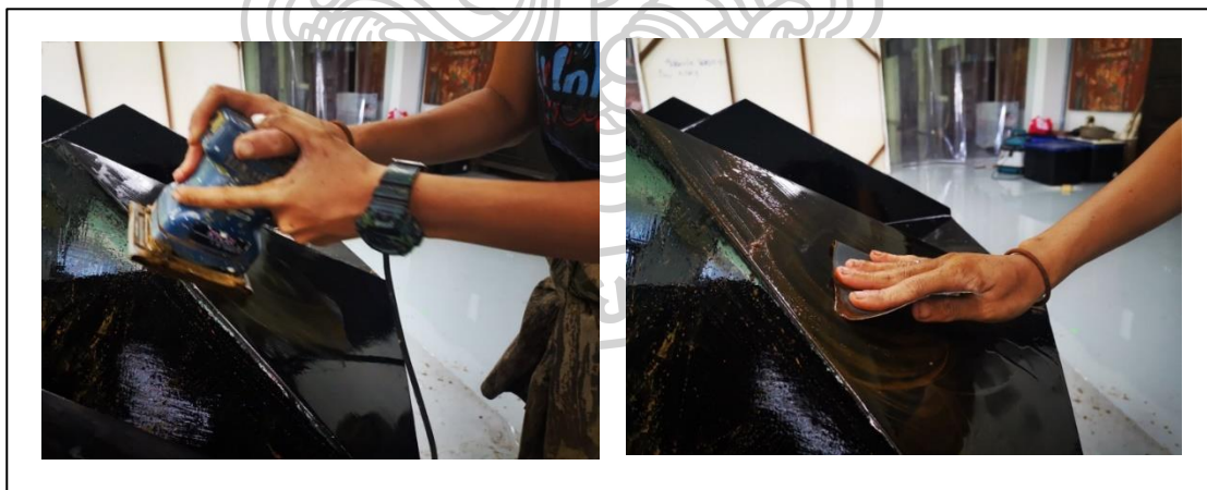
ภาพที่ 23 ภาพแสดงการขัดด้วยเครื่องขัดและการขัดด้วยมือ (ขัดเพื่อให้พื้นผิวมีความเรียบขึ้น จนกว่าจะเกิดความพอใจและในการขัดขั้นสุดท้ายต้องใช้กระดาษทรายเบอร์ละเอียดที่สุด)
