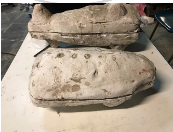
ภาพที่ 26 ภาพแสดงขั้นตอนสุดท้ายของพิมพ์ปูนปลาสเตอร์ ภาพถ่ายโดยผู้วิจัยสร้างสรรค์
