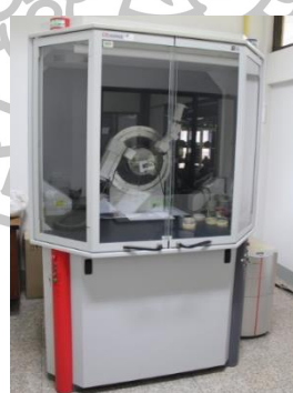
ภาพที่ 16 เครื่องการเลี้ยวเบนของรังสีเอกซ์
