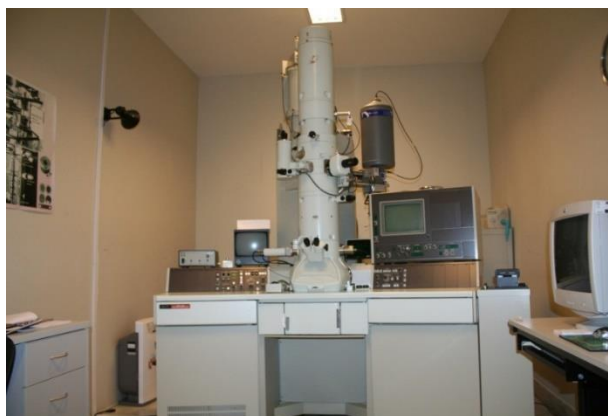
ภาพที่ 17 กล้องจุลทรรศน์อิเล็กตรอนแบบส่องผ่าน
