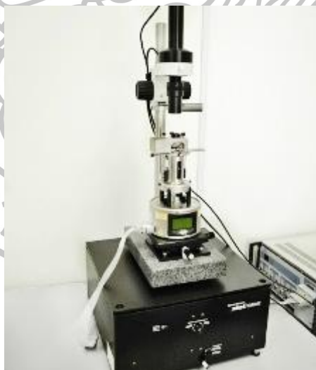
ภาพที่ 19 กล้องจุลทรรศน์แรงอะตอม
