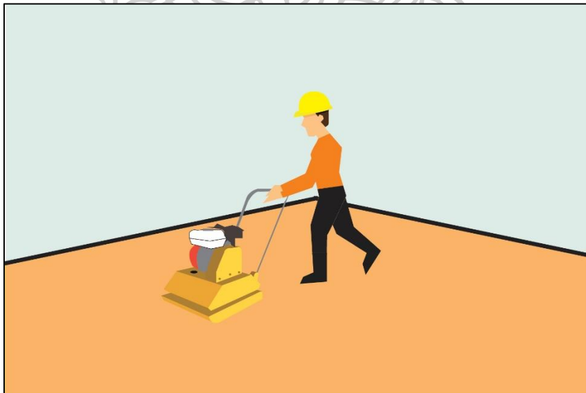
รูปภาพที่ 74 แสดงขั้นตอน บดอัดทรายด้วยเครื่องตบดิน
