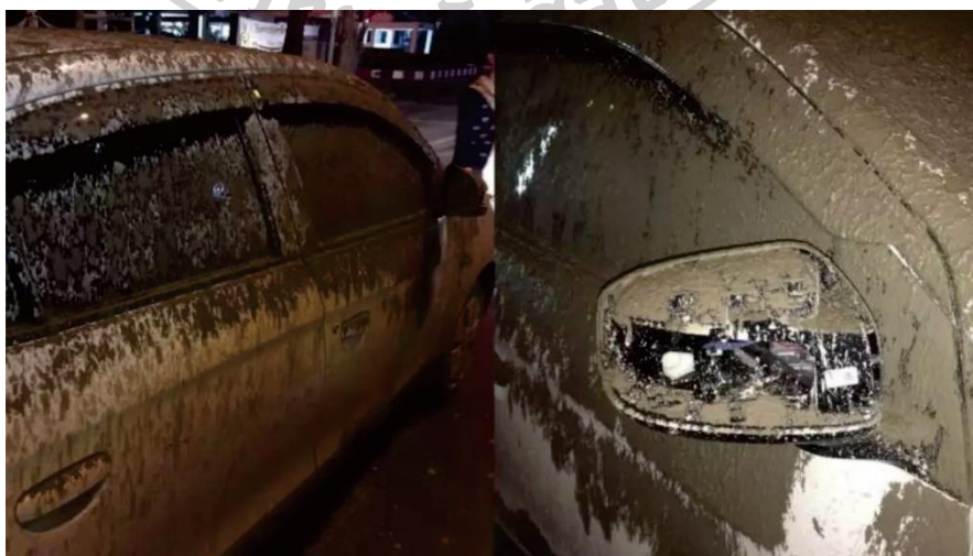
รูปภาพที่ 57 อุบัติเหตุน้ำปูนจากการก่อสร้างรถไฟฟ้าหกล้อรถที่วิ่งสัญจรอยู่ด้านล่าง
