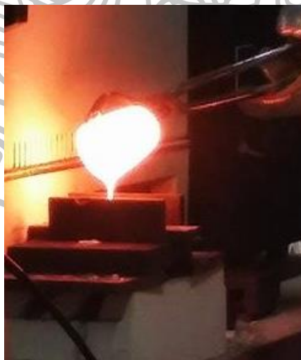
รูปที่ 24 การเทสารเคมีที่หลอมแล้วลงในแม่พิมพ์สเตนเลส
