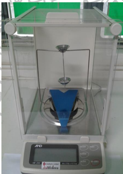
รูปที่ 26 ชุดวัดความหนาแน่นของวัสดุ โดยหลักของ Archimedes 4-digit sensitive microbalance
